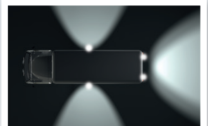
Variant C: Twee extra achteruitrijlampen aan de achterzijde plus een extra manoeuvreerlamp aan weerszijden.
