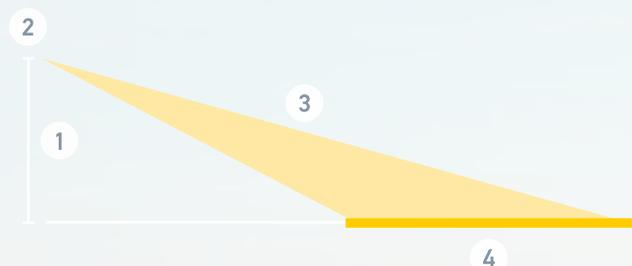
1 **Altura de montagem:** A iluminação e o campo de luz sofrem alterações consoante a altura de montagem. A altura de montagem ideal é > 2,5 m.
